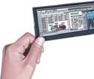
无需背光，在明亮室外也能显示鲜艳色彩的高反射型液晶（超级移动液晶）
