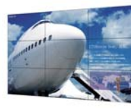
当时世界最窄的系统框架6.5mm宽的多显示器系统
