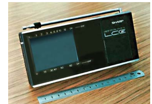
试制出的3.2英寸TFT液晶彩色电视机（1985年）
