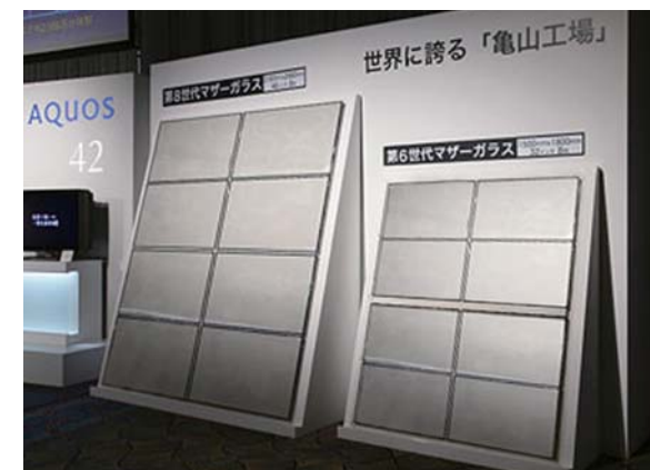
第1工厂的第6代母板玻璃（右）和2006年8月投产的第2工厂的第8代母板玻璃（左）
