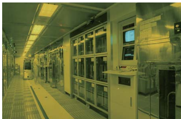
TFT彩色液晶的深加工生产线（天理工厂）
