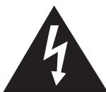
El signo del rayo con punta de flecha, en el interior de un triángulo equilátero, tiene la finalidad de avisar al usuario de la presencia de una tensión peligrosa sin aislar dentro de la caja del producto que puede ser de suficiente magnitud como para constituir un riesgo de descarga eléctrica para las personas.
