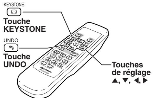
**1** Appuyez sur
