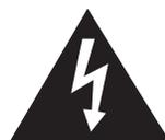
L'éclair terminé d'une flèche à l'intérieur d'un triangle indique à l'utilisateur la présence à l'intérieur de l'appareil d'une «tension dangereuse» non isolée ayant une amplitude suffisante pour provoquer une électrocution.
