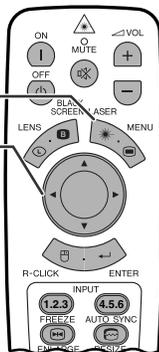
A função Imagem em Imagem permite que você possa exibir duas imagens na mesma tela. Pode-se exibir a imagem imputada pela entrada INPUT 4 ou 5 como uma inserção por sobre a imagem principal sendo imputada pela entrada INPUT 1, 2 ou 3.
