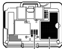
Filter à air (à ne pas retirer)    Filtre à air
