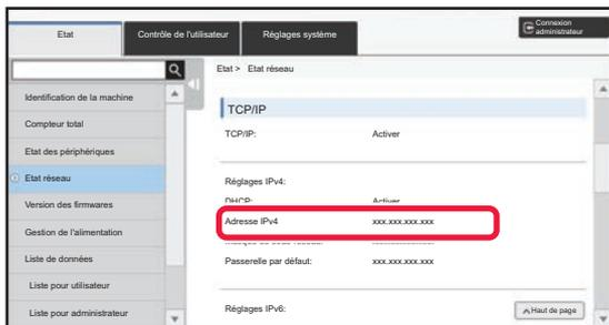
Faites défiler l'écran vers le bas et cochez « Adresse IPv4 » dans Réglages IPv4 de TCP/IP.
