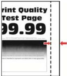
**Hinweis:** Drucken Sie die Testseiten, bevor Sie das Problem beheben. Navigieren Sie auf dem Bedienfeld zu **Einstellungen > Fehlerbehebung > Testseite drucken**. Drücken Sie bei Druckermodellen ohne Touchscreen **OK**, um durch die Einstellungen zu navigieren.
