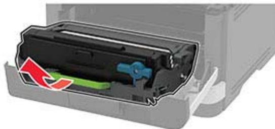
**Warnung—Mögliche Schäden:** Setzen Sie die Belichtungseinheit nicht länger als zehn Minuten direktem Licht aus. Wenn die Belichtungseinheit längere Zeit Licht ausgesetzt wird, kann dies zu Problemen mit der Druckqualität führen.
