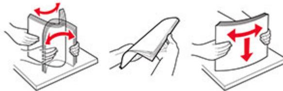
**4** Legen Sie den Papierstapel mit der zu bedruckenden Seite nach unten ein, und stellen Sie anschließend sicher, dass die Führungen eng am Papier anliegen.
