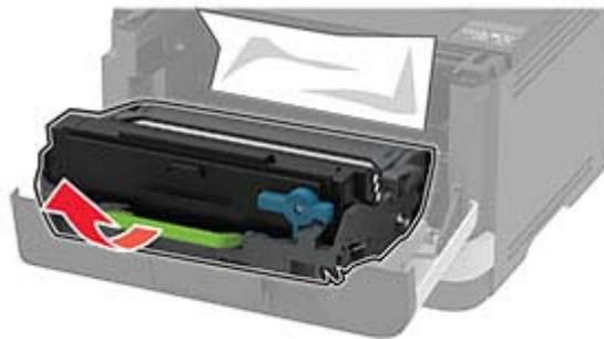
**Warnung—Mögliche Schäden:** Setzen Sie die Belichtungseinheit nicht länger als zehn Minuten direktem Licht aus. Wenn die Belichtungseinheit längere Zeit Licht ausgesetzt wird, kann dies zu Problemen mit der Druckqualität führen.
