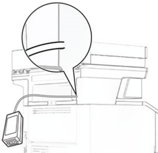
**9** Conecte un extremo del cable de alimentación de la grapadora a la fuente de alimentación y el otro a una toma de corriente eléctrica.
