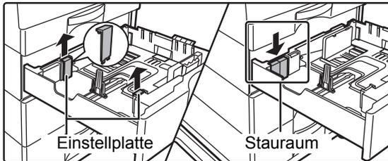
Wenn Sie Papier im Format 8-1/2" x 14" einlegen, entfernen Sie die Trennplatte A.
