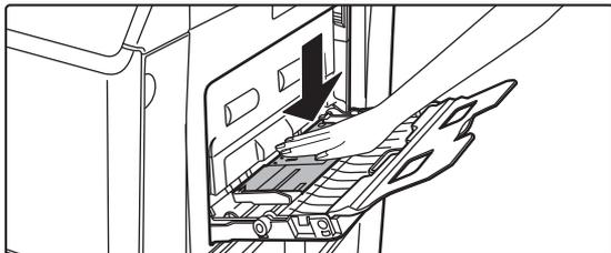
Drücken Sie die Mitte der Druckplatte nach unten, bis sie einrastet.
