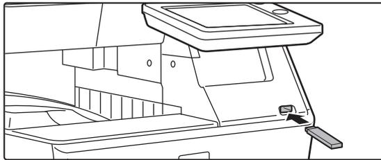
**Schließen Sie den USB-Speicher am Gerät an.**
