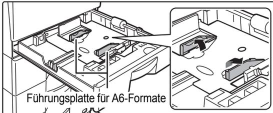
**Heben Sie die Führungsplatte für A6-Formate auf dem Vorlagenglas an.**
