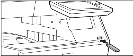
**Schließen Sie den USB-Speicher am Gerät an.**
