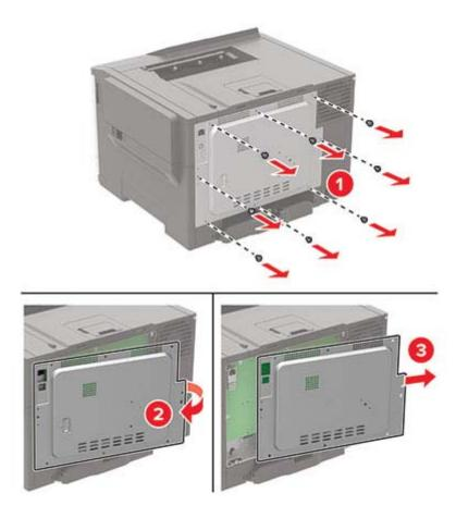
4 A l'aide d'un tournevis à tête plate, retirez le cache du port de disque dur du capot d'accès à la carte logique.
