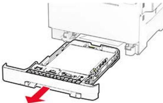
**Avertissement—Danger potentiel :** Un capteur dans le tiroir en option peut facilement être endommagé par l'électricité statique. Touchez une surface métallique avant de retirer le papier coincé dans le tiroir.
