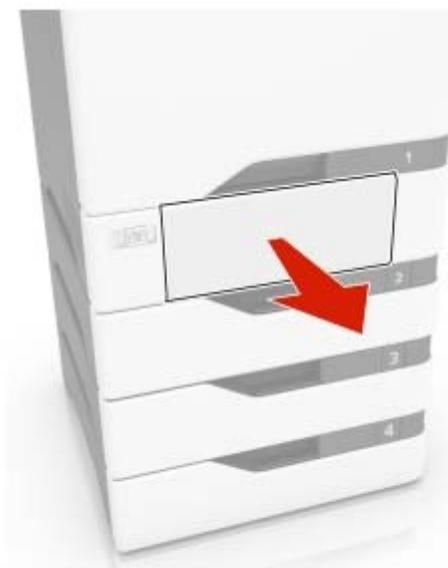
**Varning – risk för skador:** En sensor i tillvalsfacket skadas lätt av statisk elektricitet. Rör vid en metallyta innan du tar bort papperet som fastnat i facket.
