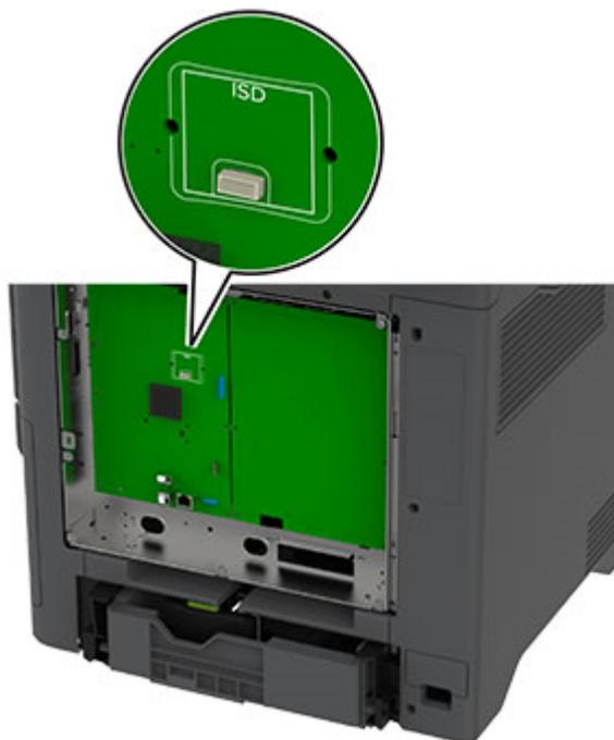
**5** Inserire la scheda nel connettore dell'unità ISD.
