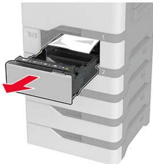
**Attenzione - Possibili danni:** un sensore all'interno del vassoio opzionale viene facilmente danneggiato dall'elettricità statica. Prima di rimuovere la carta inceppata nel vassoio, toccare una superficie metallica.
