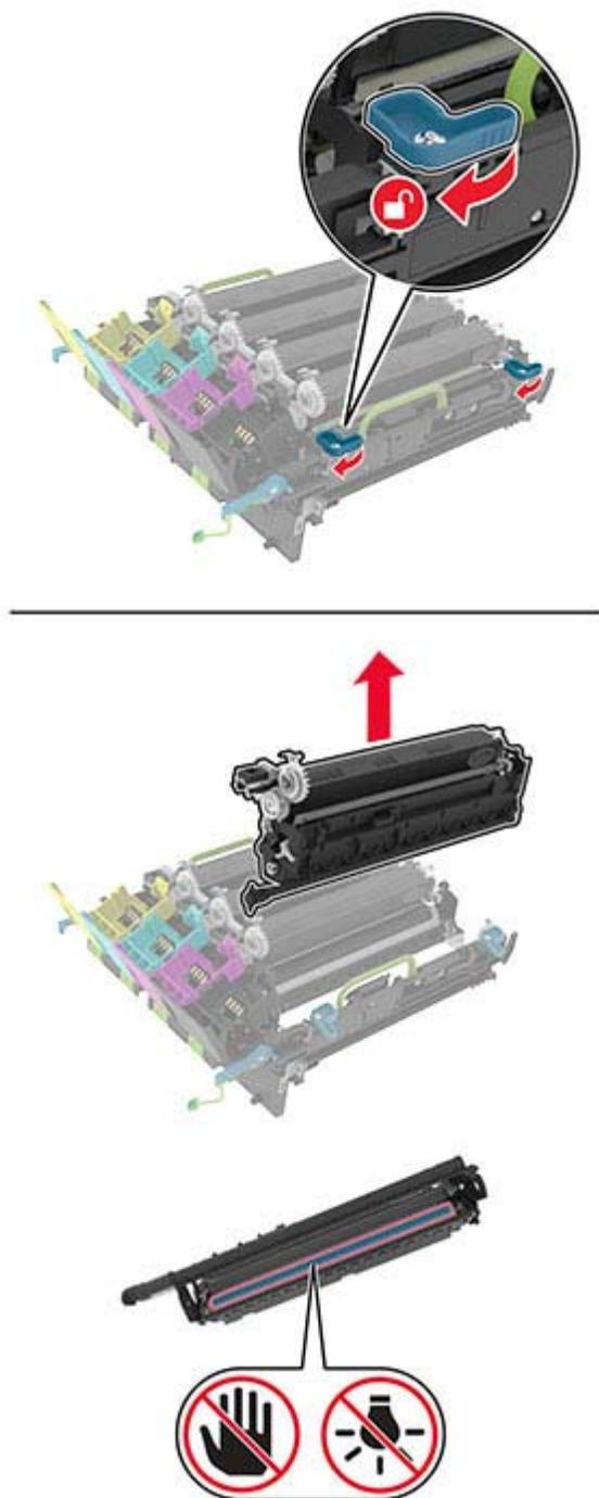
**Attenzione - Possibili danni:** Non esporre l'unità fotoconduttore alla luce diretta per più di 10 minuti. L'eccessiva esposizione alla luce può compromettere la qualità di stampa.
