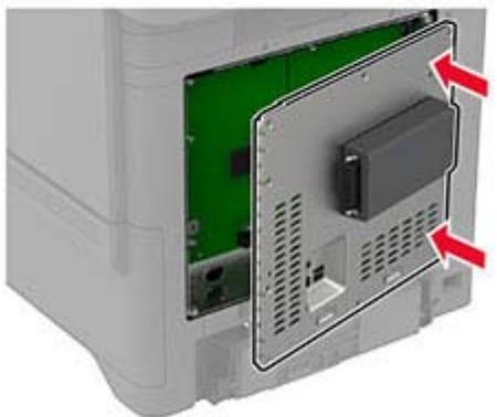
**6** Fissare la schermatura della scheda del controller.
