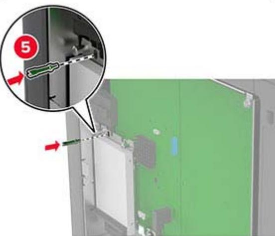
5 Fissare la schermatura della scheda del controller.
