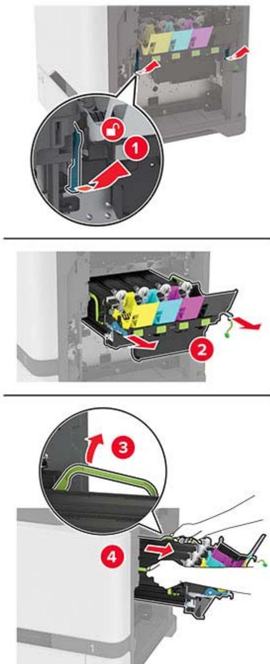
**Nota:** Per evitare di graffiare il kit di imaging o di danneggiare il tamburo del fotoconduttore, posizionare il kit di imaging in posizione verticale.
