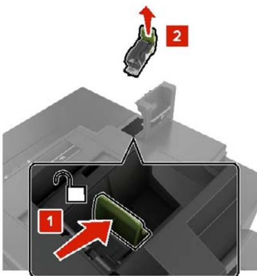
**3** Deschideți garda capsatorului și scoateți capsele slăbite.
