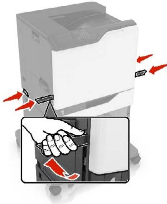
**Notă:** Dacă sunt deja instalate tăvi optionale, deblocați-le din imprimantă înainte de a ridica imprimanta. Nu încercați să ridicați imprimanta și tăvile simultan.
