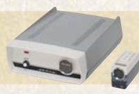
1959年 / TW-3 采用无线方式, 可进行电源、频道和音量的操作
