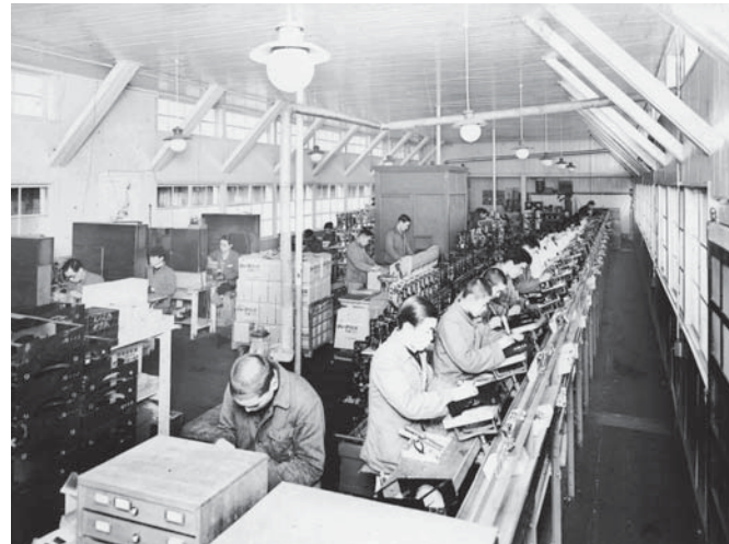
使用间歇式传送带的收音机生产线（1936年前后）
