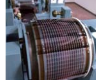
以划时代Roll to Roll方式实现量产的非晶硅太阳能电池
