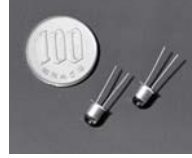
可同时发射近红外光和可视光的双色发光二极管
