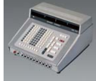
世界首创采用全晶体管和二极管的台式电子计算器“Compet”
