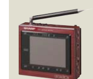
TFT式3英寸液晶彩色电视机“Crystaltron”
