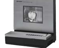
高亮度长寿命薄膜EL元件成功用于电视机影像播放(照片是1977年的产品)
