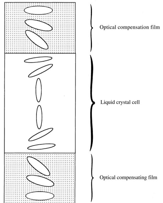
Fig. 14 The optically compensation method.<sup>20,21)</sup>
