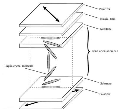
Fig. 9 The OCB mode.<sup>9)</sup>
