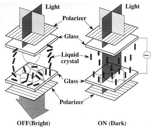
Fig. 2 The amorphous TN method.<sup>2)</sup>
