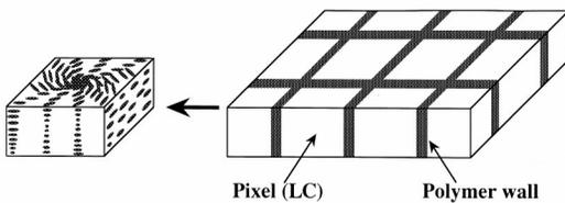
Fig. 6 The ASM method.<sup>7)</sup>
