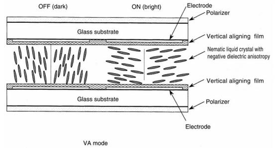
Fig. 10 The VA mode.<sup>10)</sup>
