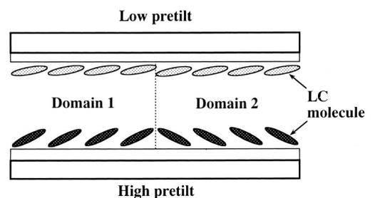
Fig. 3 The C-TN method.<sup>3)</sup>
