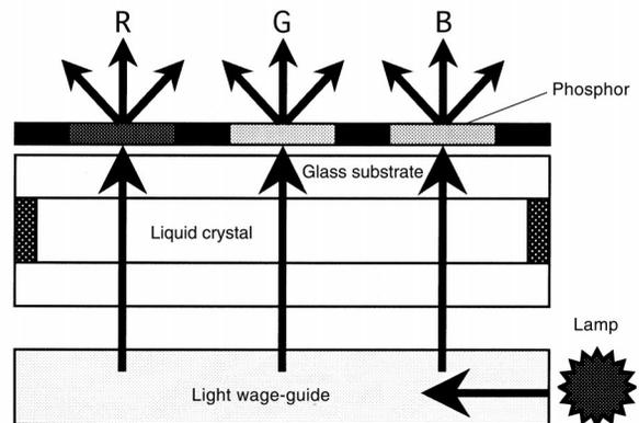
Fig. 15 The photo-Luminescent LCD.<sup>22)</sup>
