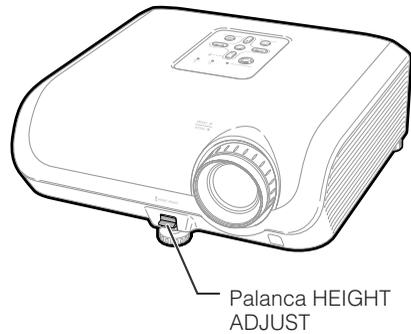
**2 Retire sus manos de la palanca HEIGHT ADJUST del proyector después de haber ajustado la altura.**
