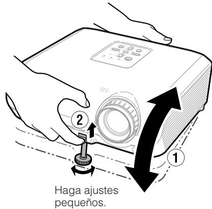
**3 Use la pata de ajuste trasera para nivelar el proyector.**
