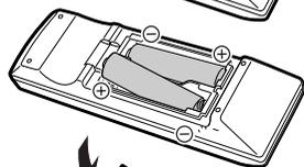
**3** Inserte la lengüeta inferior de la tapa en la abertura y cierre la tapa hasta que encaje en su sitio (oír un chasquido).
