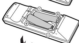
**3** Insérez l'attache à la base du couvercle dans la fente, et enfoncez le couvercle jusqu'à ce qu'il s'enclenche.
