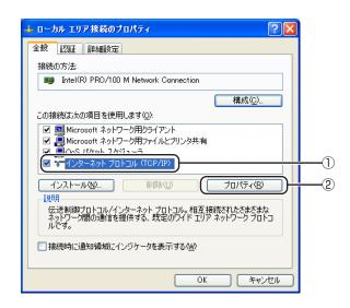
6 設定用コンピュータのIPアドレスを確認・変更する
