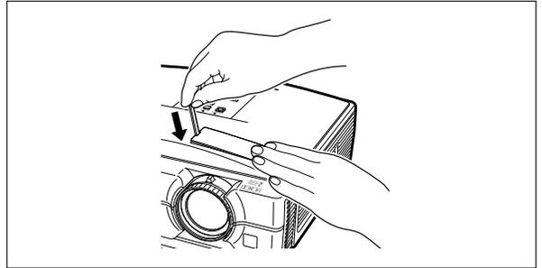
**2** 握住鏡頭防止其跌落的同時，沿著“UNLOCK”（解鎖）方向滑動鏡頭固定鎖環凸片。
