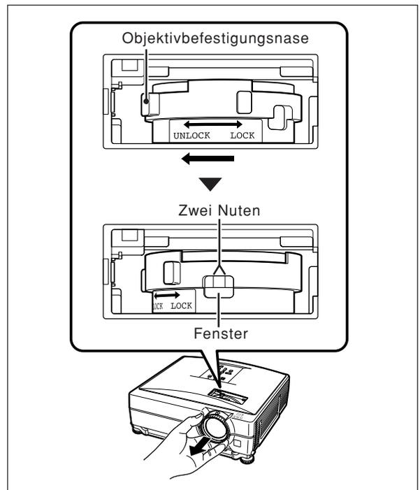
**3 Entfernen Sie das Objektiv, indem Sie es geradlinig herausziehen.**
