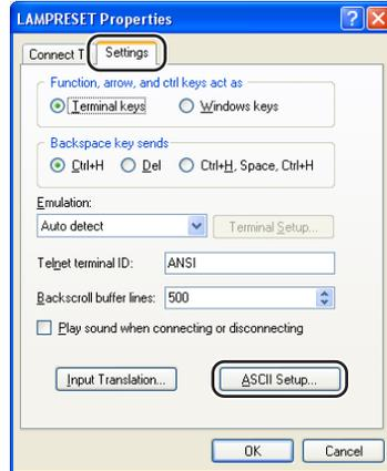
**7** 選擇“Send line ends with line feeds”（行尾傳送換行符號）、“Echo typed characters locally”（回應輸入的字元）和“Append line feeds to incoming line ends”（在連入的每行行尾附加換行符號）旁邊的核取方塊，然後按一下“OK”（確定）。
