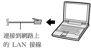
**2** 將 LAN 接線（UTP 接線、5 類雙絞線）連接到投影機的 LAN 端子，將接線的另一端連接到電腦的 LAN 端子。
