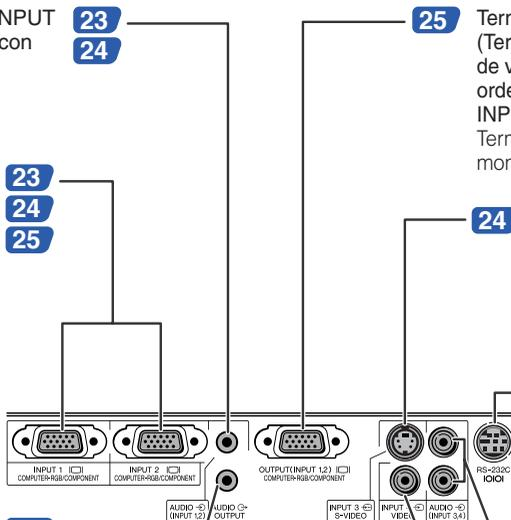
Terminal OUTPUT (INPUT 1, 2) (Terminal de salida de señales de vídeo componente y RGB de ordenador compartido para INPUT 1 y 2)
