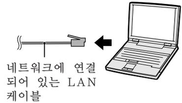
**2** LAN 케이블(UTP 케이블, 5번 카테고리, 크로스오버 타입)을 프로젝터의 LAN 단자에 연결하고 케이블의 다른 한 쪽은 컴퓨터의 LAN 단자방향으로 연결합니다.
