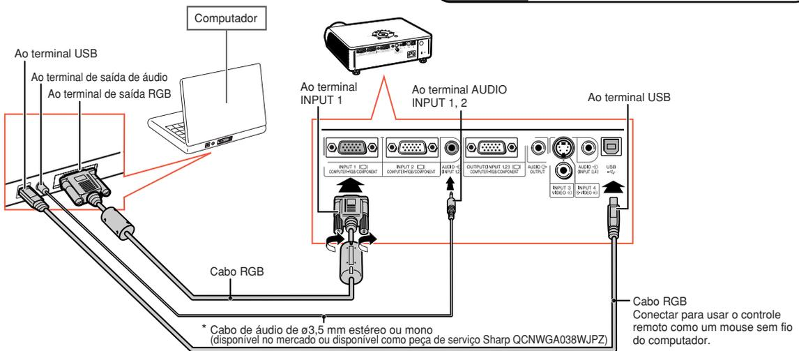
\* Ao usar o cabo de áudio mono de  $\varnothing 3,5$  mm, o volume será a metade do que se usar o cabo de áudio estéreo de  $\varnothing 3,5$  mm.
