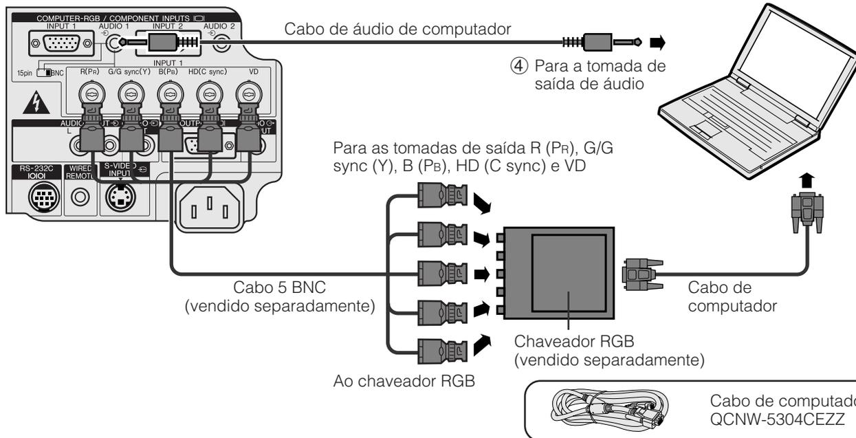
**Função "Plug & Play" (quando da conexão a um terminal de 15 pinos)**
