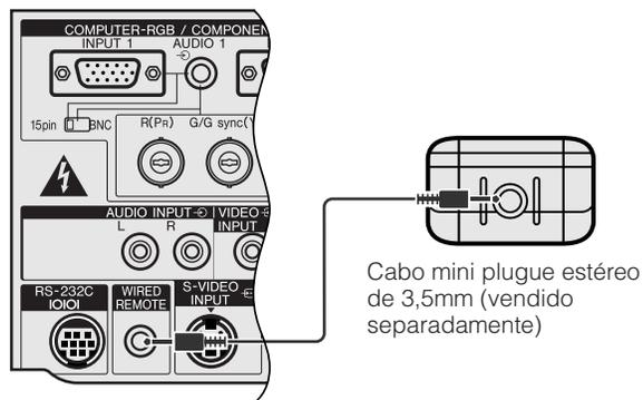
Quando o controle remoto não puder ser usado devido ao alcance ou ao posicionamento do projetor (projeção traseira, etc.), conectar um cabo mini plugue estéreo de 3,5mm (vendido separadamente) à tomada de entrada de controle remoto a fio na base do controle remoto e à tomada de entrada de controle remoto a fio WIRED REMOTE na traseira do projetor.
