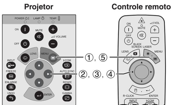
Essa função permite desativar as mensagens que aparecem no visor durante as funções “input select” e “IrCOM”. Uma vez que a função “Mostrar OSD” está definida para “○” no menu GUI, as mensagens no visor não aparecerão quando as teclas **INPUT** e **IrCOM** forem pressionadas.
