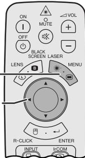
Ao exibir padrões de computador muito detalhados (ladrilho, faixas verticais, etc.), pode ocorrer interferências entre os pixels LCD, causando oscilação, faixas verticais ou irregularidades no contraste em partes da tela. Se isso ocorrer, ajuste os itens do de menu “Clock”, “Phase”, “Horiz.” e “Vertic.” para melhorar a imagem do computador.
