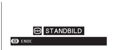
Mit dieser Funktion kann ein bewegtes Bild sofort als Standbild angezeigt werden. Diese Funktion kann verwendet werden, wenn ein Standbild von einem Computer- oder Videobild gezeigt werden soll und mehr Zeit für eine Erklärung benötigt wird.
